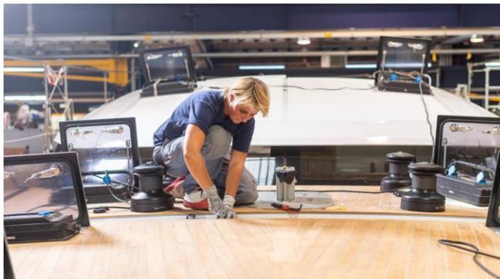
**L'accastilleur :** Il habille le pont du bateau et pose les matériels d'équipements, de manœuvre et de navigation sur les bateaux de plaisance. Il opère seul ou en équipe selon l'importance du navire à équiper.
